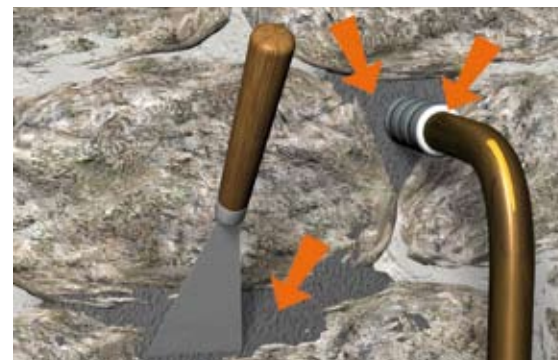
Situation après travaux : colmatage des voies d'eau.
