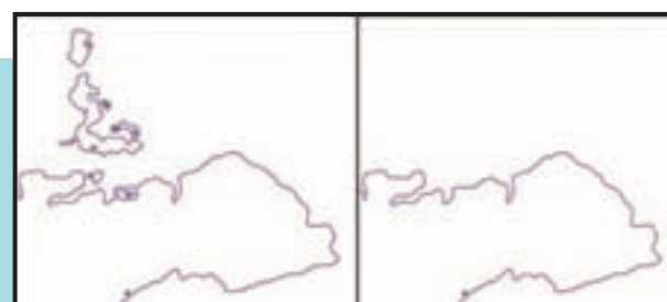
Figura 234. Edición de la poligonal del dominio. La imagen de la izquierda corresponde a la curva de nivel a cota 40. En la imagen derecha, se han eliminado las líneas que no corresponden al borde del dominio (la zona de estudio queda a la derecha de dicha línea de cota para cada imagen).
