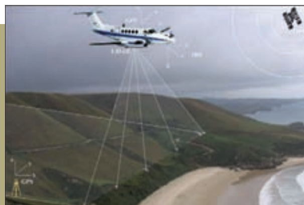
Figura 1. Toma de datos del LIDAR (fuente: DIELEMO).
