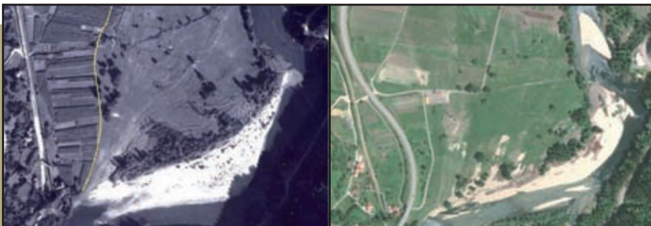
Figura 103. En la imagen de la izquierda, en la franja ubicada a la derecha de la línea amarilla, se reconocen numerosas alineaciones morfológicas relacionadas con su alta inundabilidad. En la imagen de la derecha, se observa el aspecto de la zona poco después de una inundación.
