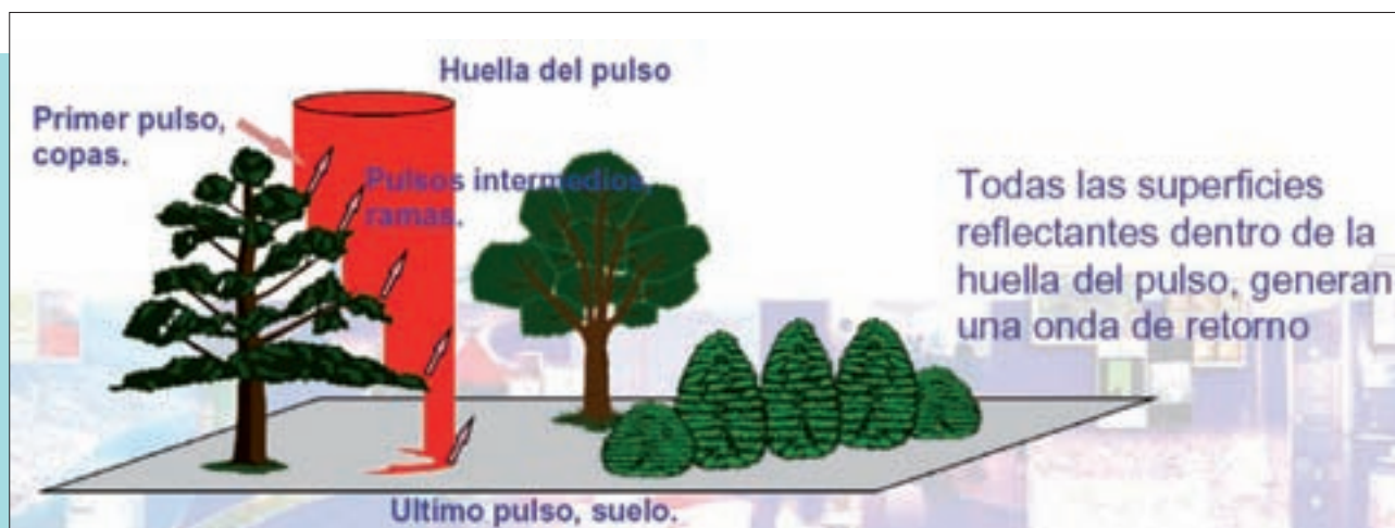
Figura 2. Toma de datos del LIDAR (fuente: INCLAM).
