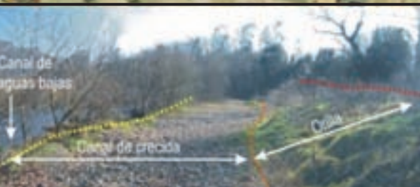
Figura 126. El modelo de pendientes LIDAR identifica varios taludes en las zonas señaladas con círculo rojo, pero la ortofoto y las observaciones de campo permiten confirmar que la línea roja es la que representa el límite del cauce actual (río Nalón, Asturias).
