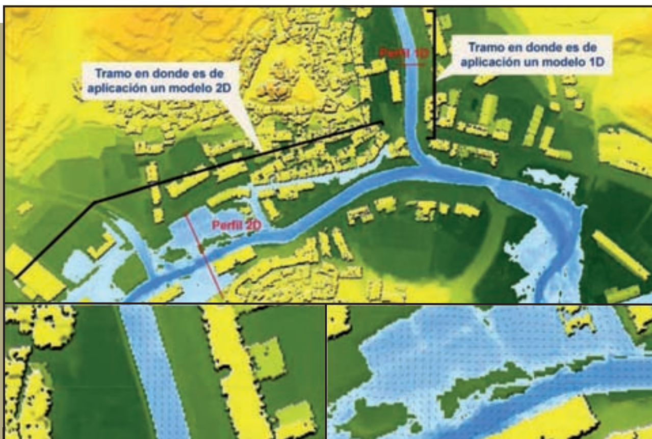
Figura 199. Casos de aplicación de modelos uni y bidimensionales. Contraste de sus campos de velocidades.
