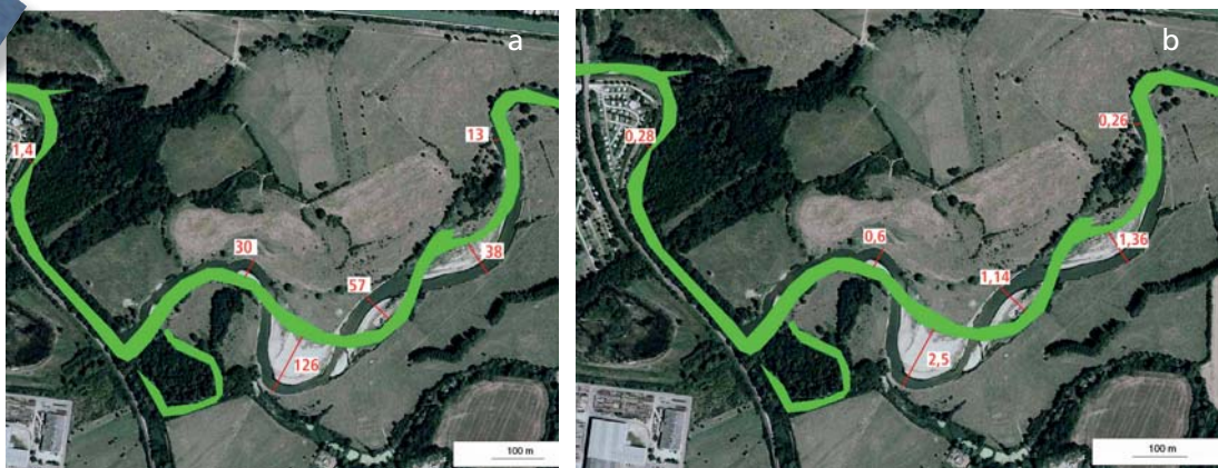
Mesures de flèches d'érosion (a) en valeurs brutes et (b) en taux annuels entre 1950 (tracé vert) et 2002 (photo aérienne) environ. Le méandre le plus actif présente une flèche de 126 m, soit un taux d'érosion moyen annuel de 2,5 m/an.
