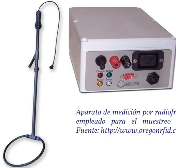
*Aparato de medición por radiofrecuencia RFID, empleado para el muestreo de sedimentos. Fuente: <http://www.oregonrfid.com/>*
