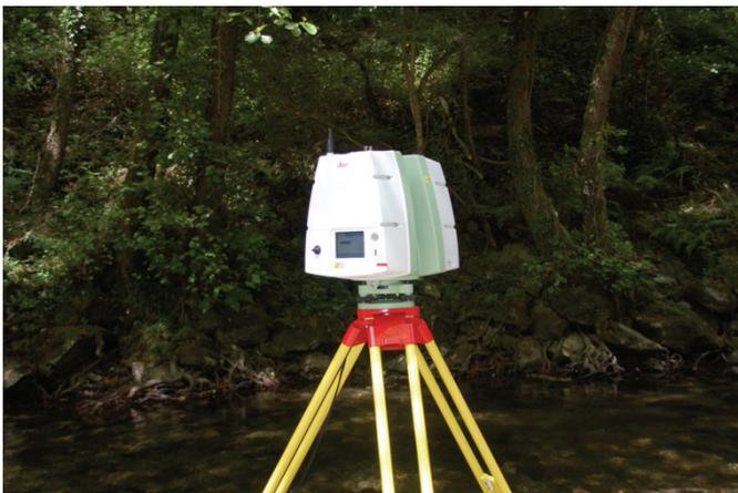
*Escáner digital terrestre utilizado en el seguimiento del derribo de la presa de Inturia (río Leitzaran, Andoian, Gipuzkoa). Foto: Askoa Ibisate.*
