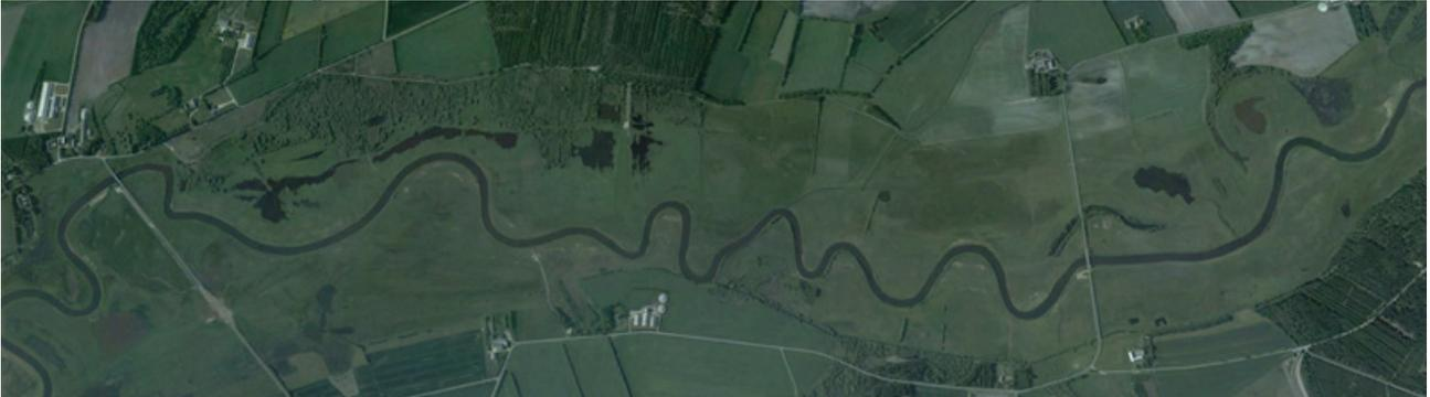
*Restauración mediante reconexión de los antiguos meandros eliminando canalización rectilínea en el curso bajo del río Skjern (Dinamarca). Foto: Google Earth.*
