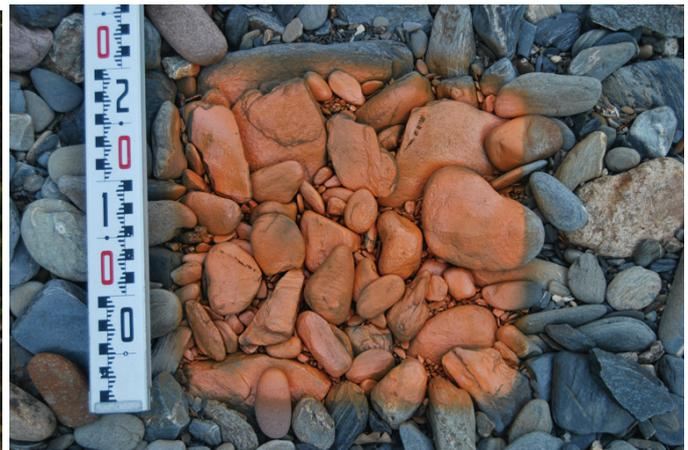
*Muestra de la coraza de sedimentos en una de las campañas de seguimiento del río Urumea tras el derribo del azud de Mendaraz. Foto: Vanesa Acín.*
