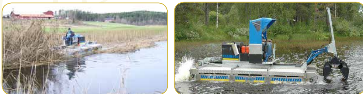
Figura 5. a) Máquina anfibia multifuncional “Truxor”, trabajando en aguas profundas con un apero para cortar cañas. Foto: Dorotea Mekaniska AB. b) Máquina “Truxor” equipada con una pala excavadora. Foto: Dorotea Mekaniska AB.
