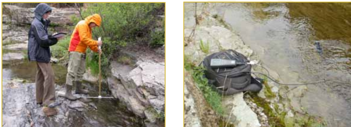
Figura 8. Medida del caudal de un curso de agua con un caudalímetro (izquierda) y sonda multiparamétrica empleada para determinar in situ la conductividad eléctrica, el pH, la temperatura y el oxígeno disuelto en el agua (derecha). Fotos: Marc Ordeix y Laia Jiménez.
