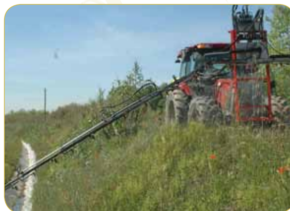
Figura 11. Pulverizador de presión hidráulica con barra de gran amplitud de inclinación para aplicación en taludes, desarrollado por TOMIX. Fotos: Ilídio Moreira.
