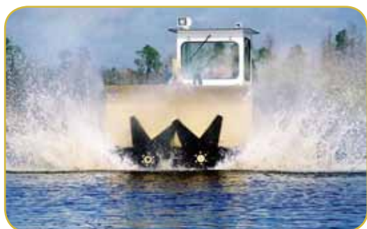
Figura 8. a) Vista frontal de la embarcación, detalle de cuchillas y la pantalla protectora detrás éstas. Foto: Aquarius Systems. b) Vista lateral de la embarcación triturando la vegetación. Foto: Aquarius Systems.
