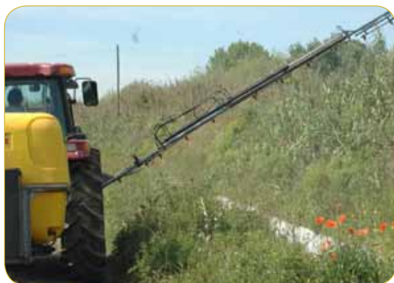
Figura 11. Pulverizador de presión hidráulica con barra de gran amplitud de inclinación para aplicación en taludes, desarrollado por TOMIX. Fotos: Ilídio Moreira.
