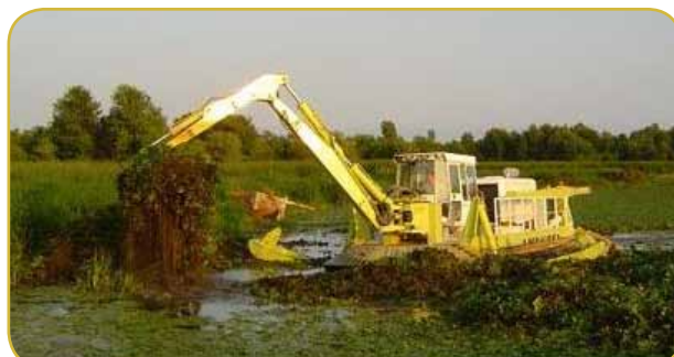
Figura 7. a) Representación del área de trabajo de la máquina "Watermaster by Aquamec". Dibujo: Aquamec Ltd. b) Máquina "Amphibex" retirando con una pala rastrillo vegetación acuática de un río. Foto: Normrock Industries Inc.
