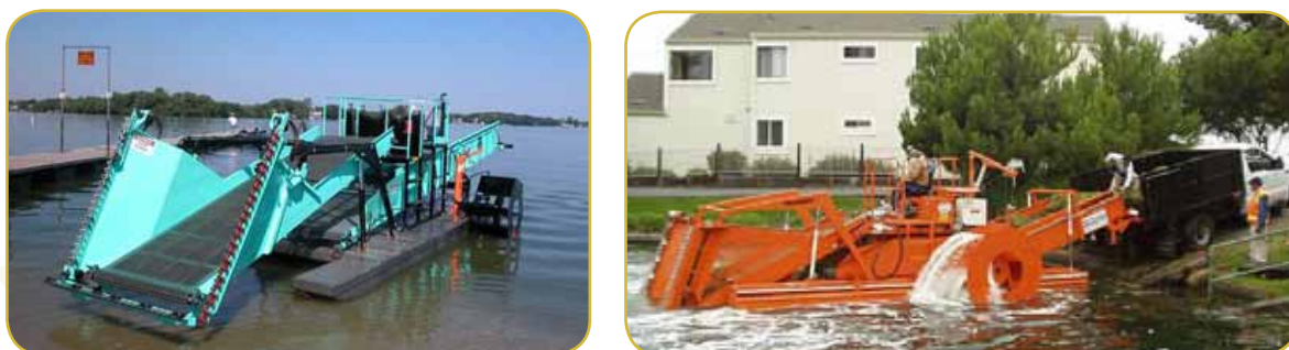
Figura 9. a) Detalle de zona de carga con la cinta transportadora y las cuchillas de sierra frontales de la “Cosechadora de malezas acuáticas”. Foto: Inland Lake Harvester, Inc. b) Detalle de la descarga de material cosechado mediante cinta transportadora trasera a un camión. Foto: Aquarius-System Inc.
