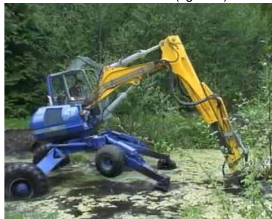
Figura 3. a) Representación del área de trabajo de retroaraña. Dibujo: Menzi Muk. b) Retroaraña trabajando en un río.
