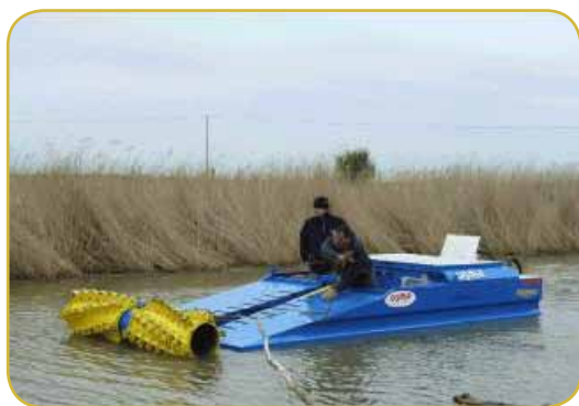
Figura 6. a) Lancha motora segadora de herbáceas. Foto: Osma snc. b) Lancha motora con pala cargadora. Foto: Aquarius Systems.
