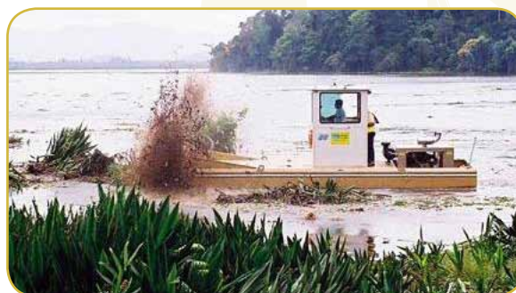
Figura 8. a) Vista frontal de la embarcación, detalle de cuchillas y la pantalla protectora detrás éstas. Foto: Aquarius Systems. b) Vista lateral de la embarcación triturando la vegetación. Foto: Aquarius Systems.
