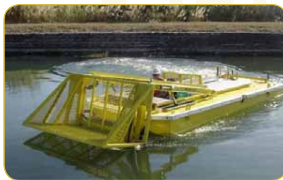
Figura 6. a) Lancha motora segadora de herbáceas. Foto: Osma snc. b) Lancha motora con pala cargadora. Foto: Aquarius Systems.
