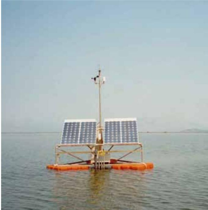
Station automatique de prise d'échantillons de paramètres physico-chimiques dans la lagune de Tsoukalio. Elle fournit des informations essentielles pour déterminer la qualité de l'eau des lagunes et de la rivière Louros
