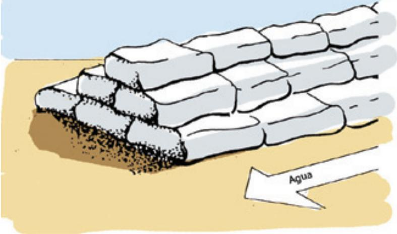
Ilustración 11: Apilamiento de bolsas de arena –apilar las bolsas de arena más alto le permitirá lograr muros más anchos.
