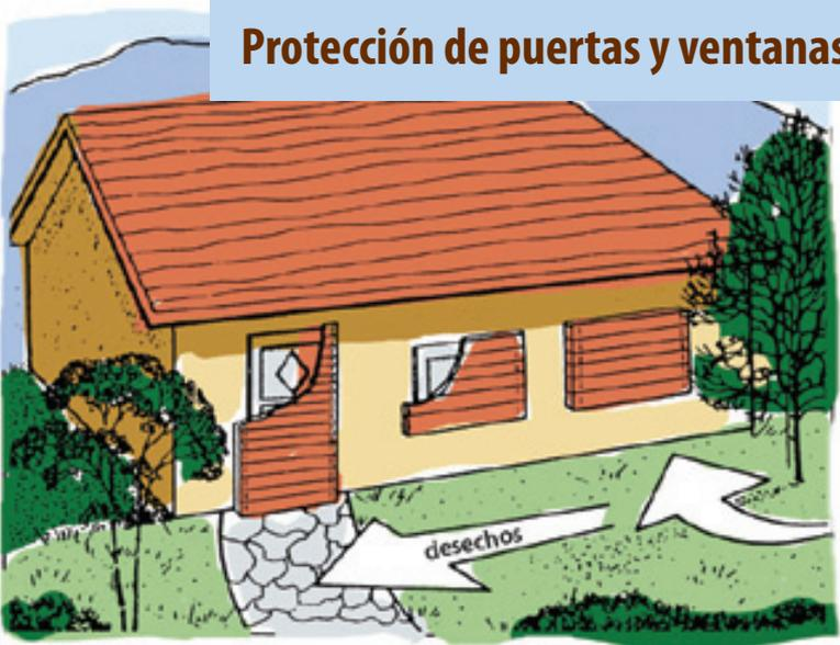
*Ilustración 13: Protección de puertas y ventanas – Use madera o madera contrachapada para ayudar a proteger las puertas y ventas de daños.*
