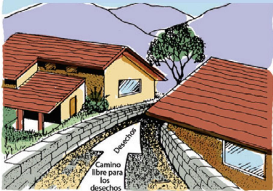
Ilustración 6: Cómo canalizar los desechos a través de los edificios, y alejarlos de estos.
