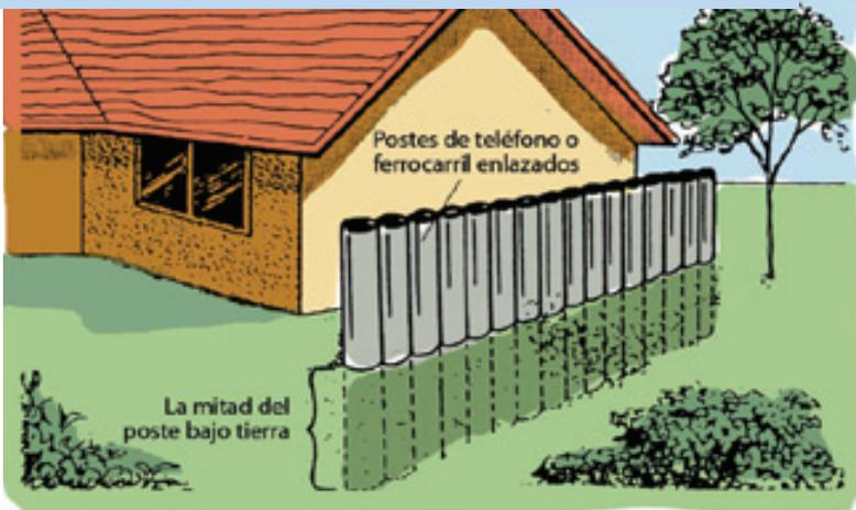
Ilustración 19: Lazo de barrera por poste de teléfono o ferrocarril – Use materiales más resistentes para instalaciones más altas que puedan tolerar condiciones extremas.
