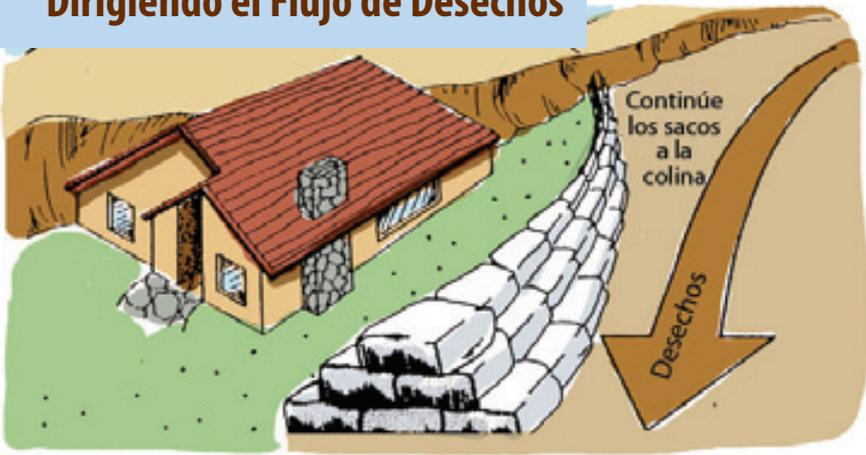
Ilustración 7: Dirigiendo el Flujo de Desechos – Utilización de un muro de bolsas de arena para desviar los desechos lejos de las estructuras.
