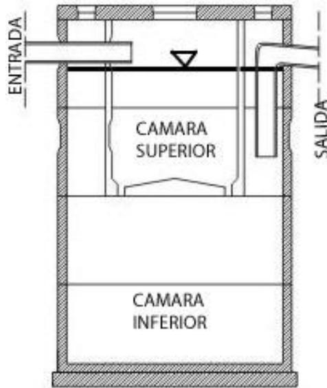
Fig. 1.- Tanque Imhoff
