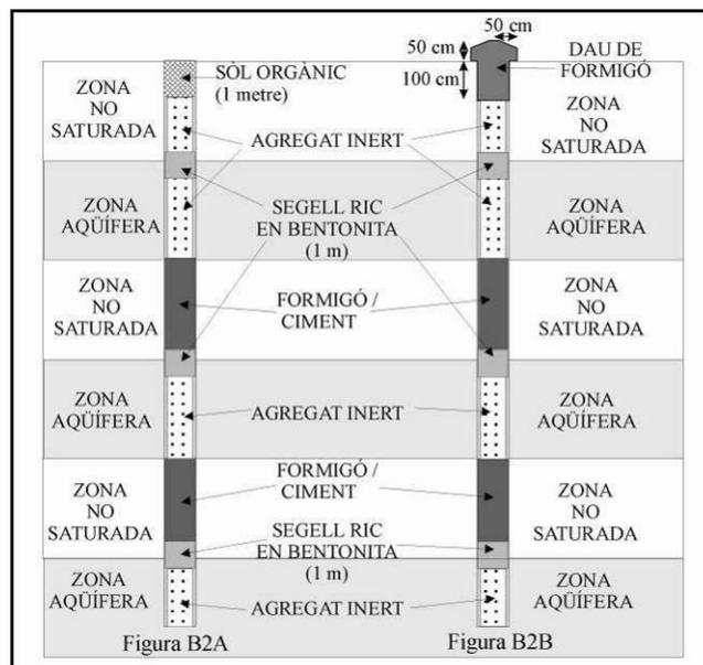
Figura B2: Esquema del procedimiento a seguir para la clausura de un pozo en acuífero multicapa.
