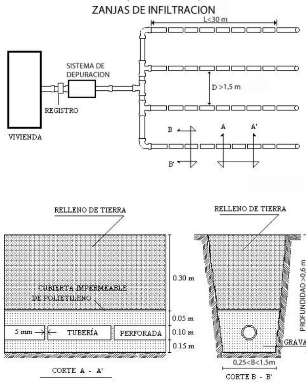
Fig 10. Zanja de infiltración
