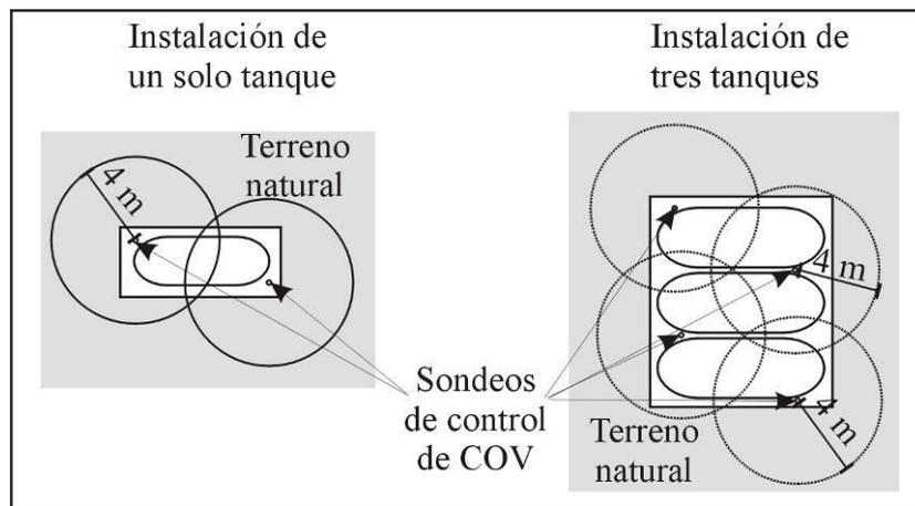
Figura 2: Distribución tipo de los sondeos de control y detección de vapores.
