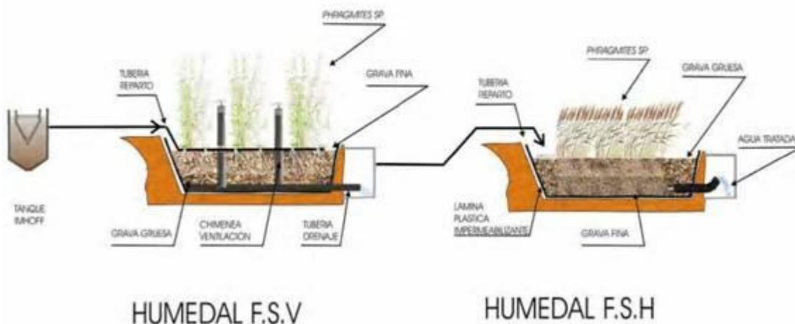
Fig. 7. Combinación de humedales artificiales
