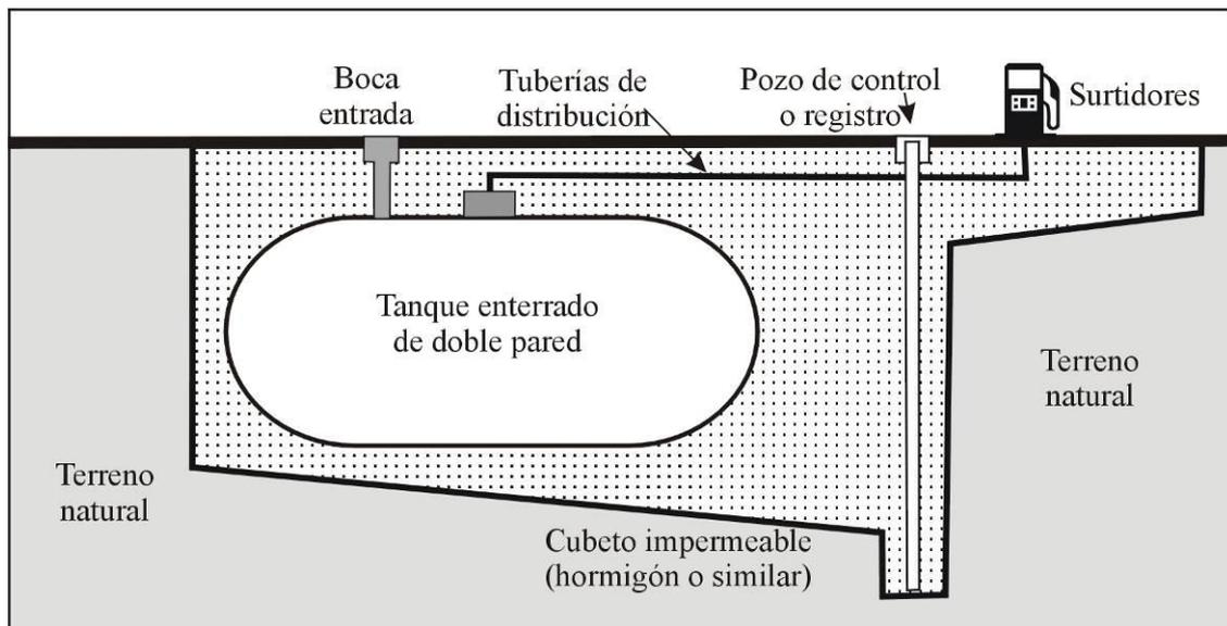
Figura 1: Dispositivo ideal que incluye tanque de doble pared y cubeto que abarca toda la instalación y que dispone de pozo de registro.
