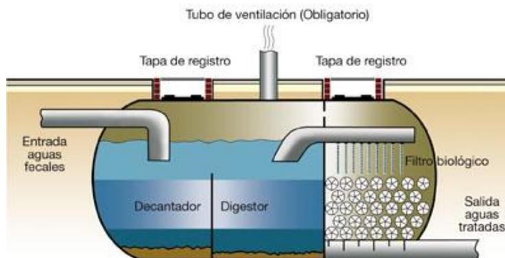
Fig. 3. Fosa séptica con filtro percolador.
