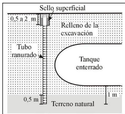
Figura 3: Sondeo tipo para detección y control de vapores.
