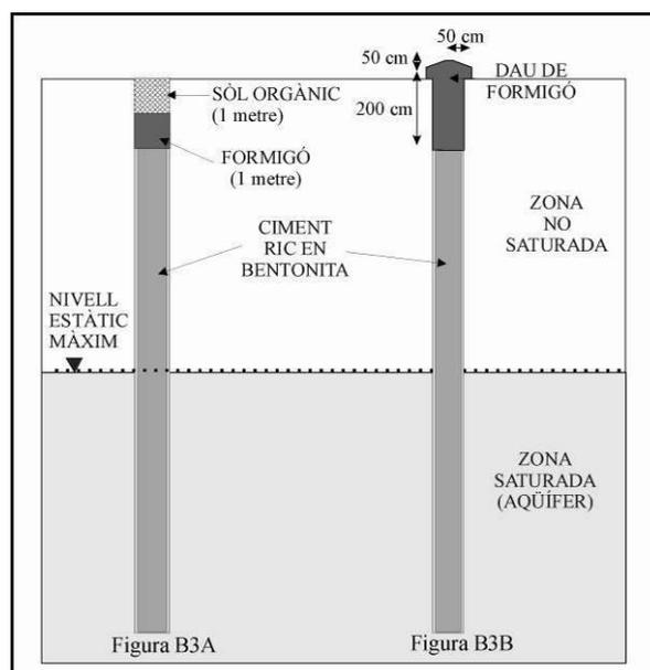
Figura B3: Esquema del procedimiento a seguir para la clausura de un pozo de características desconocidas.
