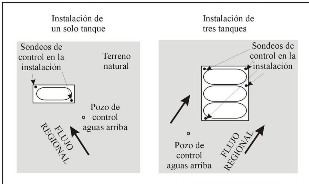
Figura 4: Distribución tipo de los pozos y sondas de control y detección de fase libre (sobrenadante).
