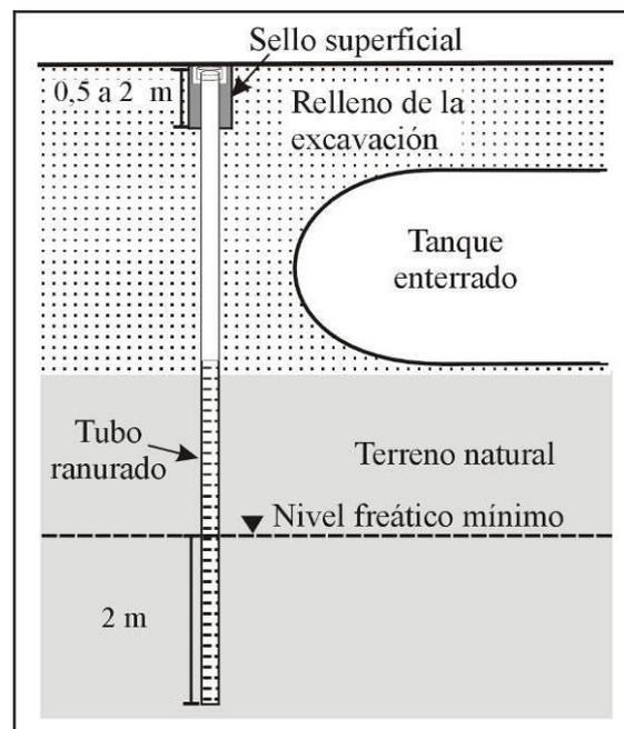
Figura 5: Sondeo tipo para detección y control de fase líquida (sobrenadante).
