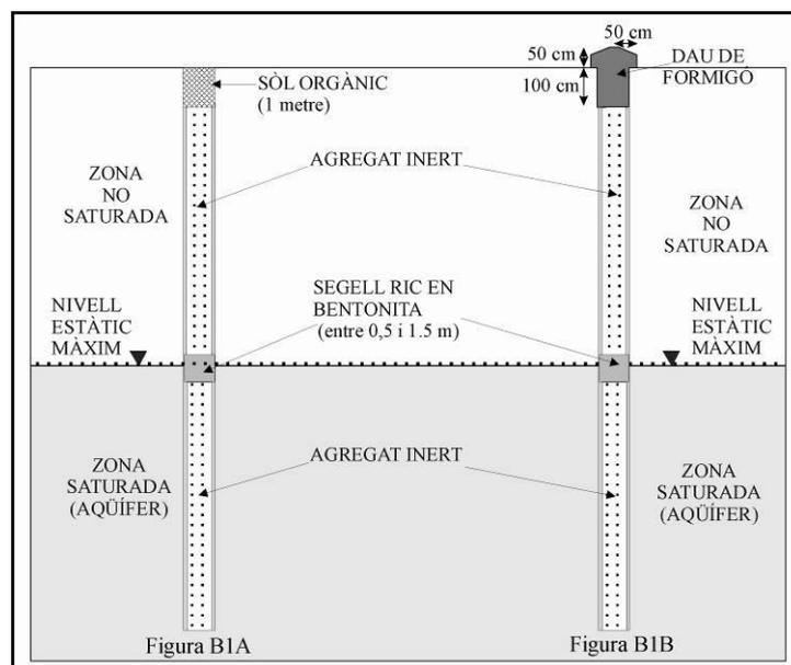
Figura B1: Esquema del procedimiento a seguir para la clausura de un pozo superficial o de acuífero único.
