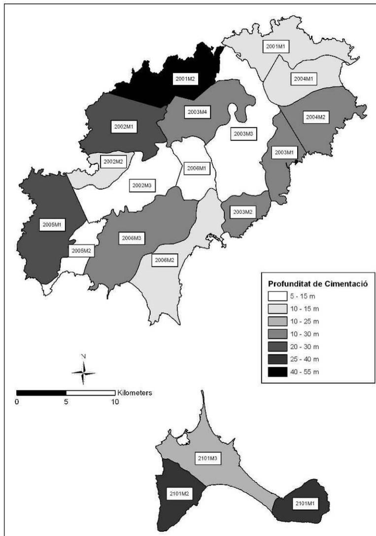
Figura A5: Profundidades de cimentación en las masas de agua Pitiüsses.
