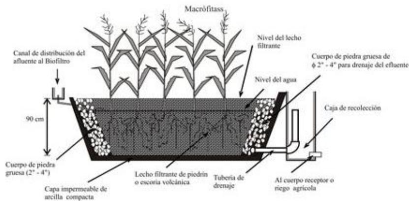
Fig. 6. Humedales artificiales de flujo subsuperficial horizontal (FSH)
