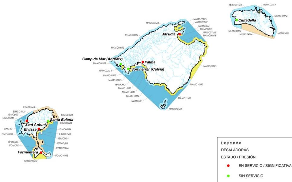
Figura 92.- PRESIÓN POR VERTIDOS DE DESALADORAS EN MASAS DE AGUAS COSTERAS DE ILLES BALEARS.
