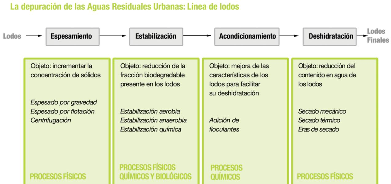
**Figura 32.- Etapas de la línea de lodos en el tratamiento de las aguas residuales urbanas.**
