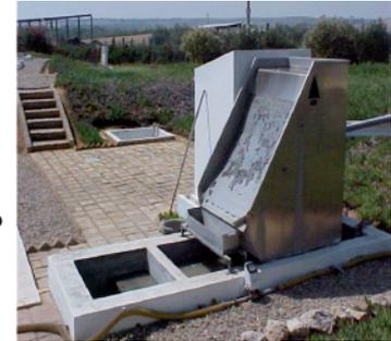
**Figura 2.- Esquema y fotografía de un tamiz estático autolimpiante.**
