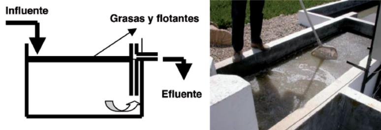
Figura 4.- Esquema y fotografía de un desengrasador estático.
