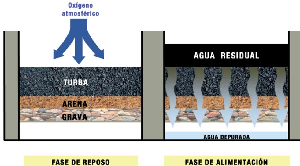
Figura 13.- *Filtros de Turba en reposo y en operación.*
