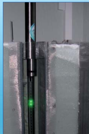
Prototype de la sonde PIVET pour la mesure des vitesses d'écoulement en forage
