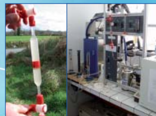
Dispositif de mesure de l'âge de l'eau en laboratoire à partir des CFCs
