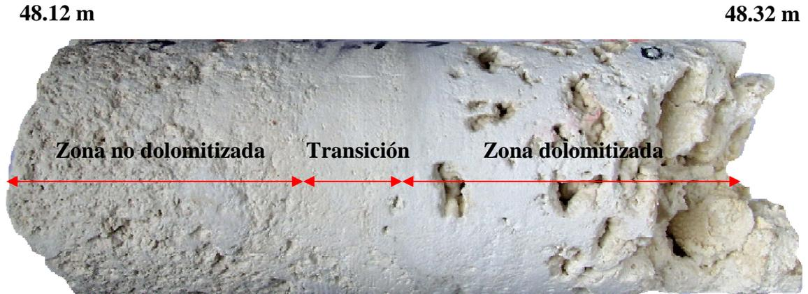
Figura 4.43.- Imagen macroscópica del testigo de sondeo MC2-O, correspondiente al tramo inferior del lagoon externo (LE), cuya cota se sitúa entre 48,12-48,32 m. El brusco incremento en el volumen y tamaño de los poros, marca claramente la zona del testigo afectada por el proceso de dolomitización (derecha) de la no afectada.
