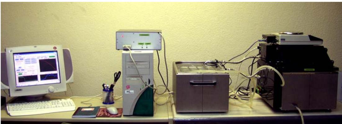
Figura 4.12.- Aspecto de uno de los tres equipos computerizados (AUTOSORC) utilizados para la determinación de las propiedades hidráulicas de los testigos procedentes del sondeo MC2.
