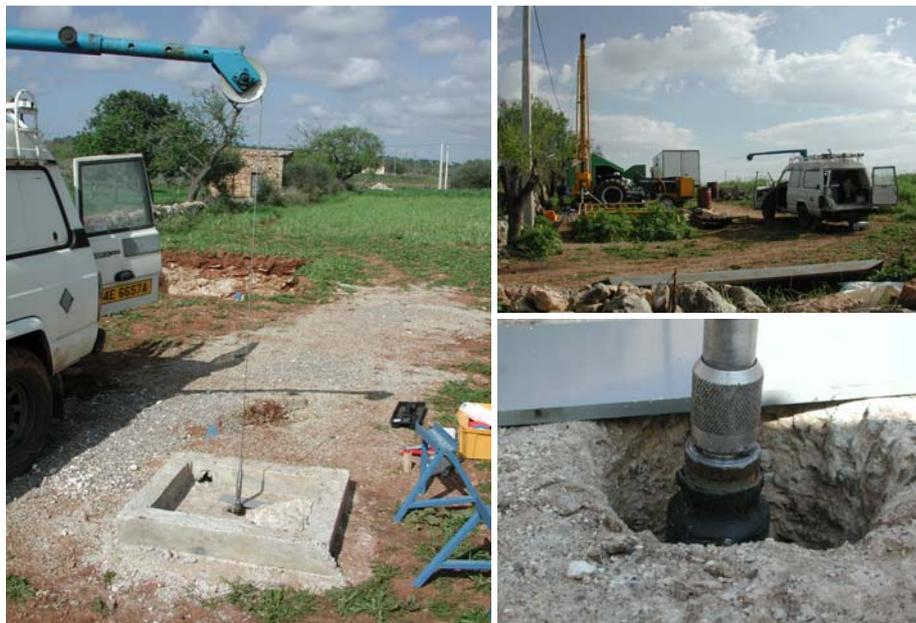
Figura 2.7.- Detalle de la campaña de “logging” llevada a cabo dentro del campo de pruebas de Ses Sitjoles. Las fotografías muestran diversos detalles de los ensayos asociados a los sondeos MC2 (izquierda) y MC1 (derecha).
