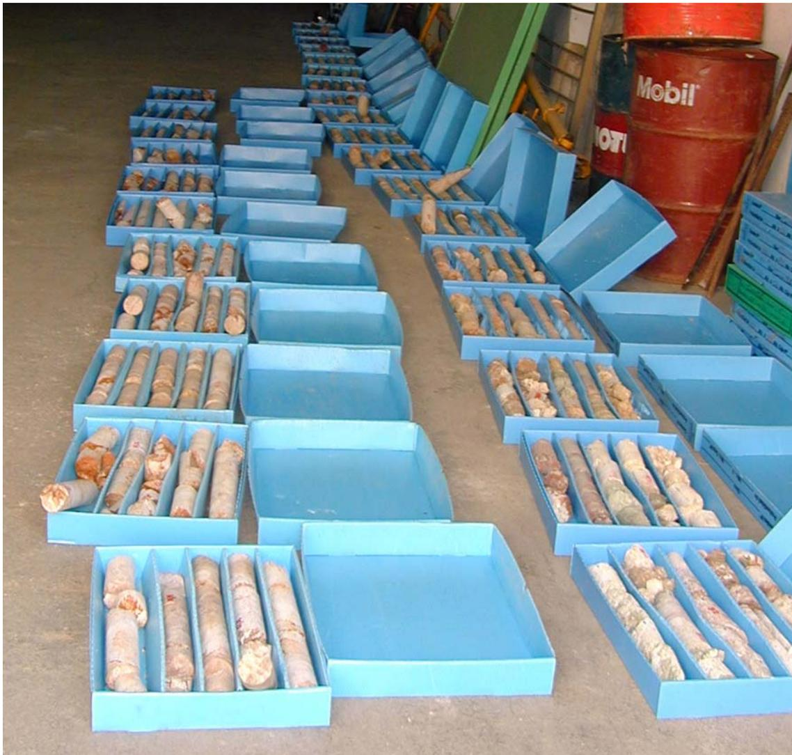
Figura 3.1.- Cajas de testigos correspondientes al sondeo MC2. El despliegue, observación y análisis detallado de los testigos de sondeo ha permitido determinar las heterogeneidades, que a escala macroscópica, están presentes dentro de cada una de las litofacies establecidas, procediendo al muestreo posterior de las zonas de mayor interés petrofísico.
