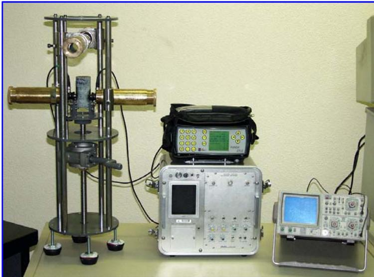
Figura 4.1.- Equipo ultrasónico y estativo utilizado para la determinación de los tiempos de vuelo de las ondas P mediante transmisión directa. Este sólido y manejable estativo utilizado para la obtención de perfiles ultrasónicos a lo largo de los testigos de sondeo, ha sido específicamente diseñado para este proyecto por el Grupo de Petrofísica de la Universidad de Oviedo.
