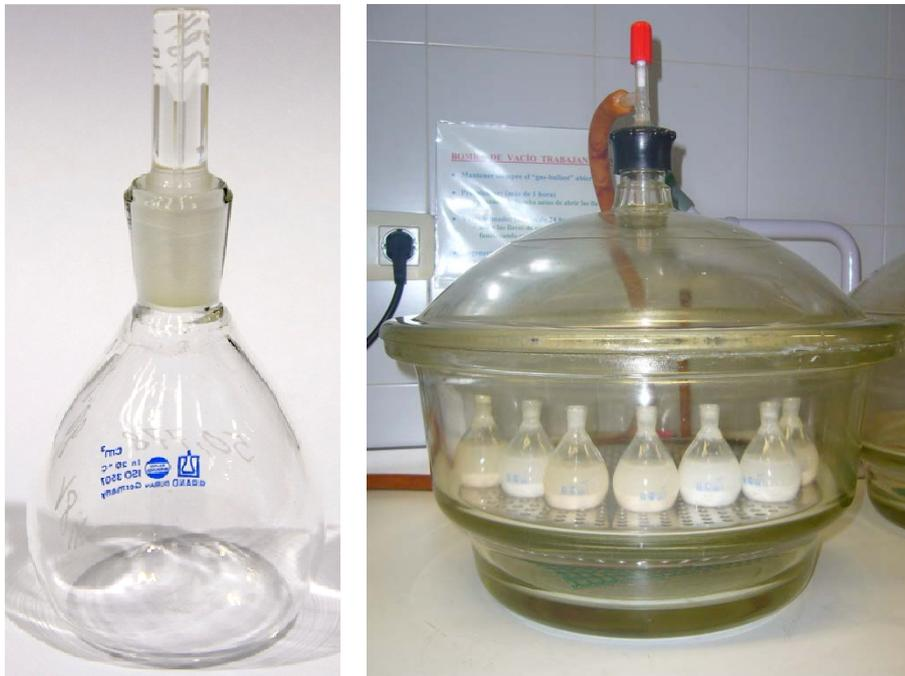
Figura 4.11.- Izquierda; Picnómetro de Le Chatelier utilizado para la determinación de la porosidad cerrada de los testigos de sondeo, con la muestra en polvo en su interior y enrasado con agua. Derecha; detalle de varios picnómetros de Le Chatelier dentro de una campana de vacío durante la realización de un ensayo.
