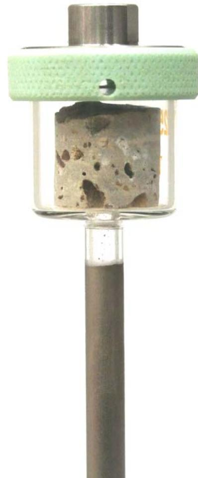
Figura 4.76.- Izquierda; Detalle del equipo AUTOPORE III (Micromeritics) utilizado en los ensayos de inyección de mercurio. Derecha; Detalle de una muestra dentro de un penetrómetro, que se introducen dentro de las cámaras de baja y alta presión del porosímetro.
