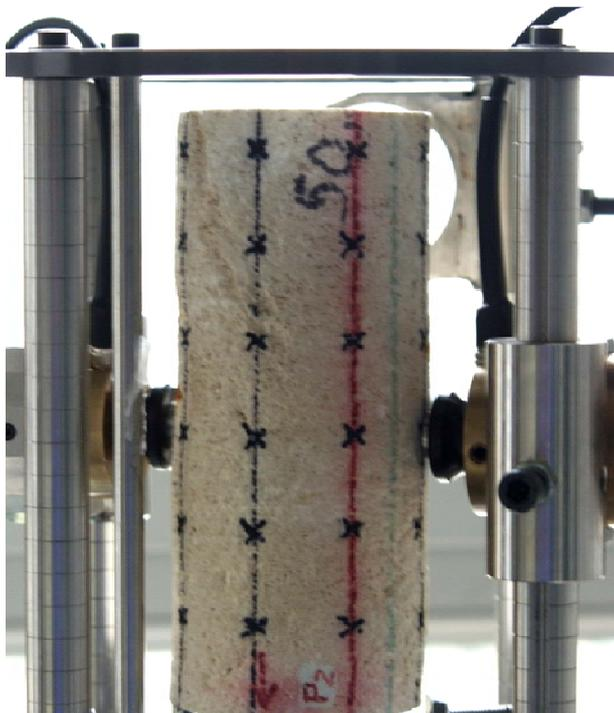
Figura 4.2.- Detalle del par de transductores (Ei-Ri) de 1 MHz colocados dentro del soporte especialmente diseñado para su sujeción. El testigo de sondeo se desplazada a lo largo de su eje longitudinal por acción de una manivela, registrando así los transductores los valores de tiempos de tránsito de las ondas P a lo largo de todo el perfil. Se han utilizado transductores Panametrics.
