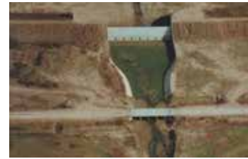
Figura 4. Reservorio para el control de crecidas (Arroyo Ludueña, Pcia de Santa Fe, Argentina).
