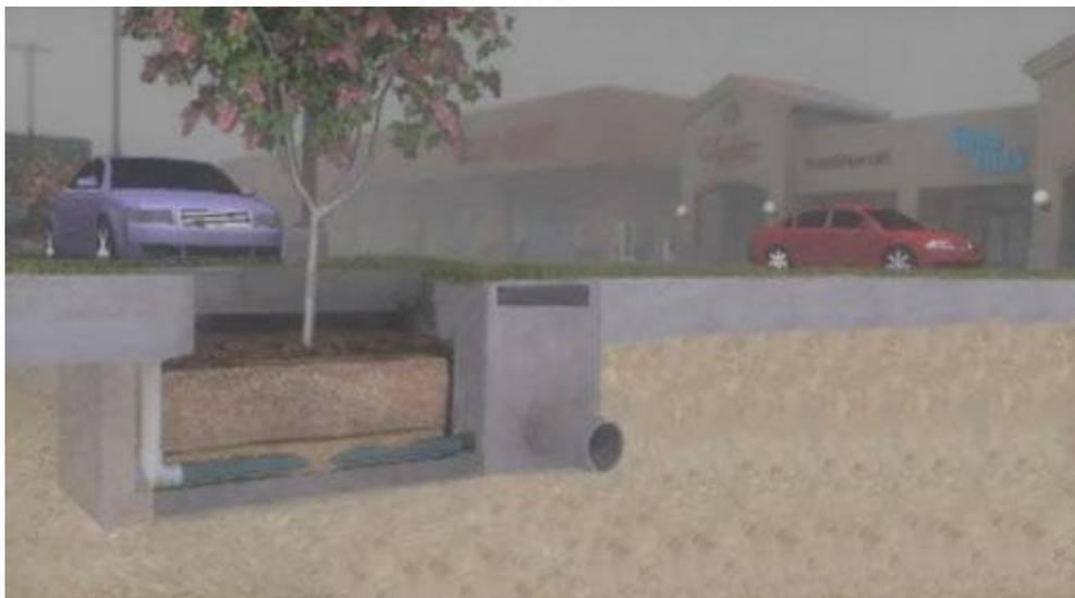
Imagen 17 Alcorque inundable con base Fuente [www.filterra.com](http://www.filterra.com)
