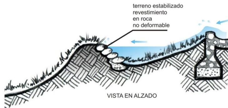
**DETALLE 6 - MONTÍCULO CON REVESTIMIENTO NO DEFORMABLE**
