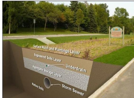
Imagen 12 Dren filtrante con capas granulares Fuente:
