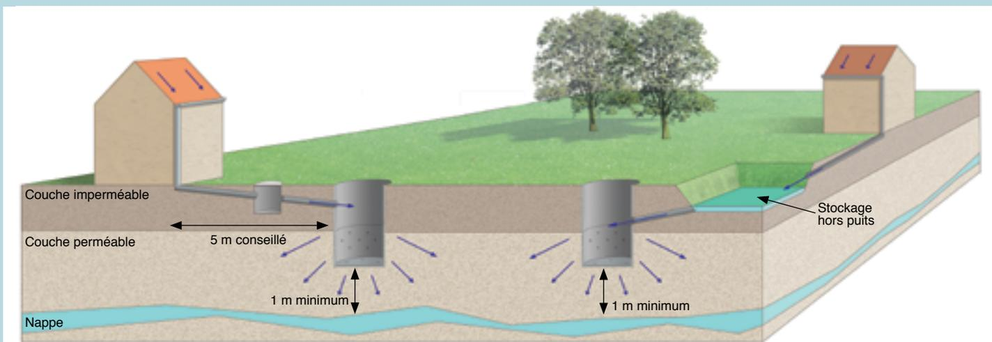
Exemples d'implantations de puits d'infiltration
