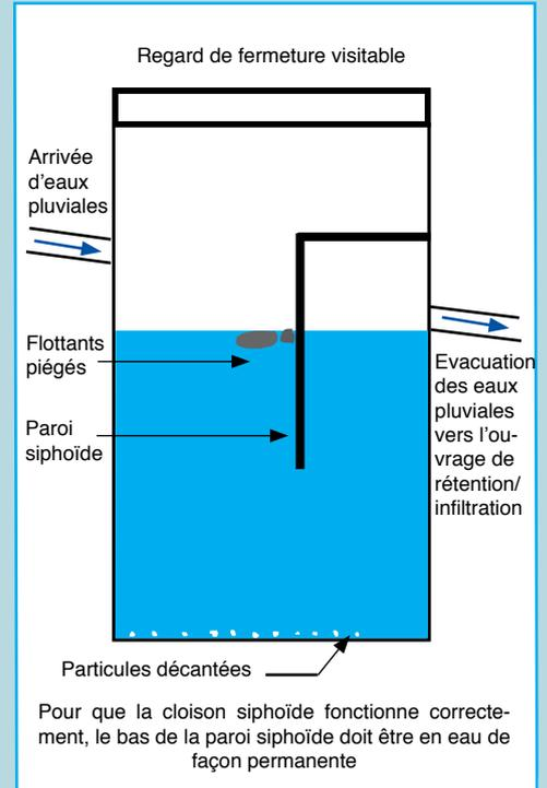
Détail de mise en oeuvre d'un regard avec décantation et cloison siphonide
