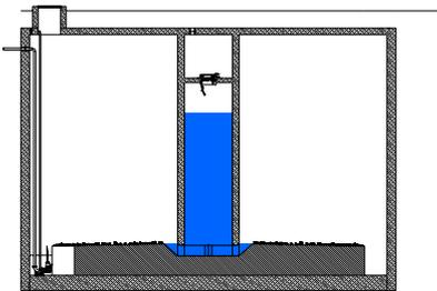
4- La tormenta termina y la cámara de retención se vacía, dejando los sólidos y sedimentos depositados en la misma.
