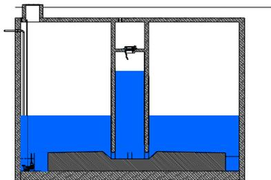
3- La bomba de succión empieza a absorber automáticamente aire, haciendo que el agua fluya de la cámara de retención hacia la cámara de limpieza debido al efecto de vacío. Una vez que se alcanza el nivel máximo en la cámara de limpieza, la bomba de succión se detiene.
