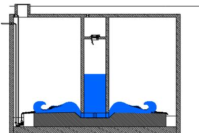
5- Una vez que el tanque está vacío, la secuencia de limpieza comienza. El gran volumen de agua almacenado barre la cámara de retención, eliminando los sedimentos almacenados en la misma.
