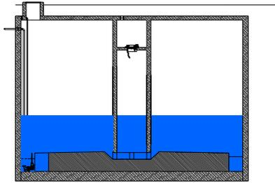
2- Comienza la tormenta. Una combinación de agua residual y de lluvia se almacena en el interior de la cámara de retención, y hacen crecer el nivel en la entrada de la cámara de limpieza.
