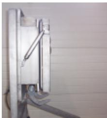
3- Después de 30 segundos, las compuertas se cierran completamente, y son bloqueadas por medio de los garfios.
