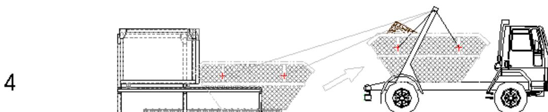
El contenedor se carga en el camión y otro contenedor se coloca en el sistema Terminodour Skip. Se desliza hacia el frente la parte superior de la estructura y se cierra la puerta para comenzar la neutralización del olor.
