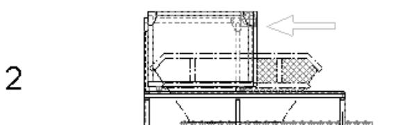
Puerta enrollable abierta. La parte superior de la estructura se desliza para liberar el contenedor. Esto puede llevarlo a cabo una sola persona
