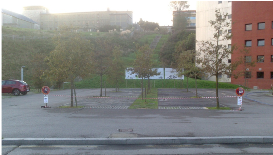
Figura 52. Imagen de las dos hileras de plazas de aparcamiento ensayadas con el LCS. Hormigón poroso reforzado con polímeros (margen izquierda de la imagen superior) y asfalto poroso (margen derecha de la imagen superior).
