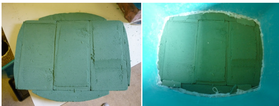
Figura 46. Detalle de la sección transversal de la capa de separación y filtración conformada por el OASIS®.
