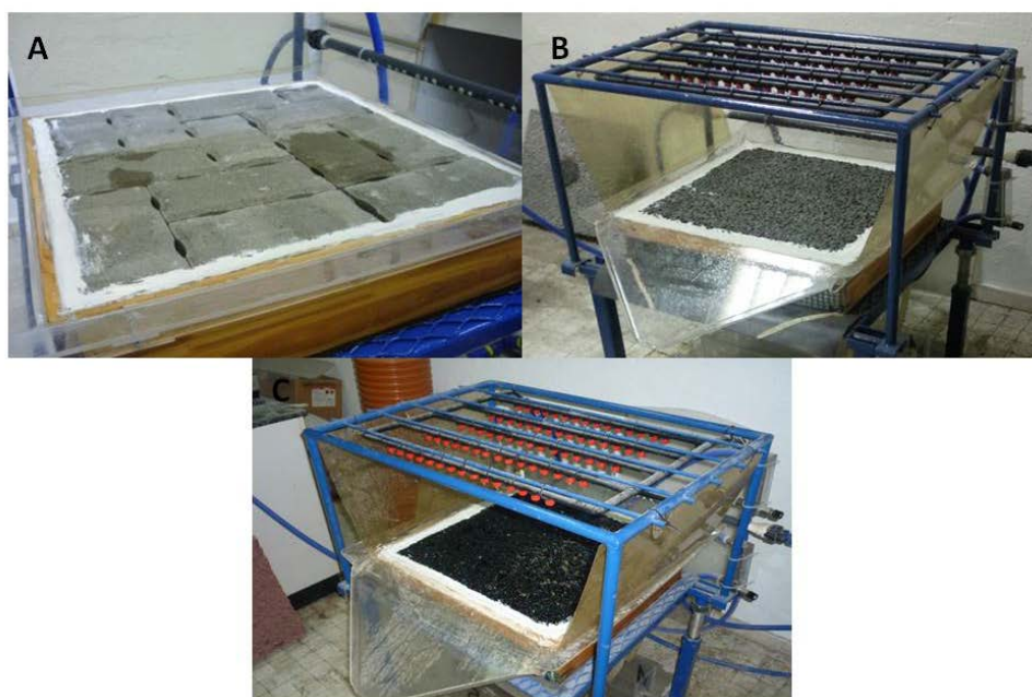
Figura 29. (A) Apariencia final de la probeta de adoquines con ranuras, (B) hormigón poroso reforzado con polímeros y (C) la probeta de asfalto poroso, dispuestas en el ICF y preparadas para ser ensayadas.
