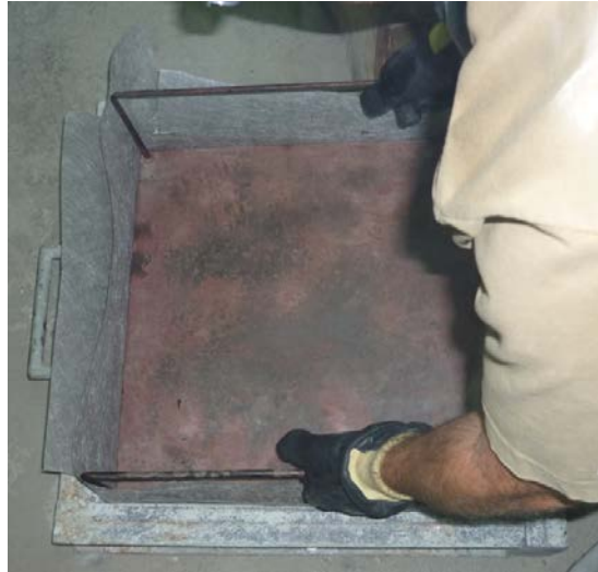
Figura 27. Detalle de la colocación del geotextil y la chapa metálica sobre la probeta de asfalto poroso.
