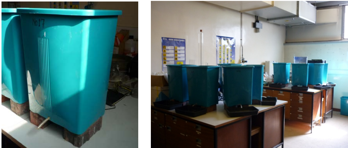
Figura 44. Contenedor utilizado para albergar la sección del firme permeable con un tubo de plástico dispuesto en la parte inferior del mismo y esquema de los 9 contenedores utilizados en los ensayos.
