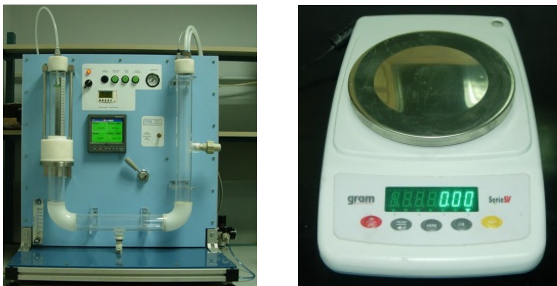
Figura 33. Ensayo de permeabilidad al agua perpendicularmente al plano sin carga según UNE-EN ISO 11058:2010 (izquierda) y ensayo de la masa por unidad de superficie según UNE-EN ISO 9864 (2005) (derecha).
