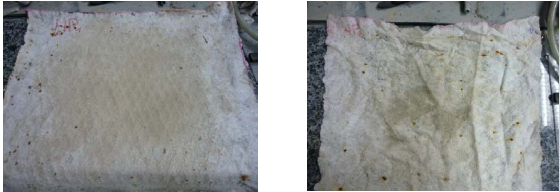
Figura 66. Detalle de los sedimentos que han infiltrado hacia el geotextil.
