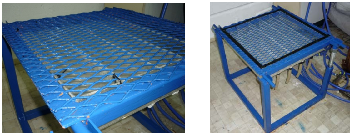
Figura 17. Recipiente receptor atado al bastidor metálico del ICF mediante bridas de plástico (izquierda) y disposición de la cinta americana a modo de sellado perimetral (derecha).
