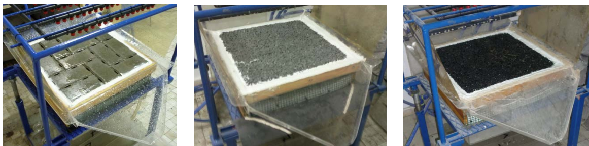
Figura 32. Detalle de las superficies permeables ensayadas en el ICF. Adoquines impermeables en disposición permeable (izquierda), hormigón poroso reforzado con polímeros (centro) y asfalto poroso (derecha).
