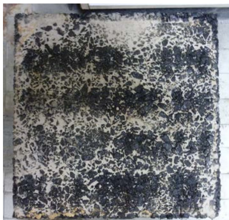
Figura 51. Zonas principales de medida con el LCS en laboratorio en las probetas de superficies permeable de aglomerado poroso utilizadas en el ICF (izquierda) y detalle de los sedimentos atrapados en las superficies.
