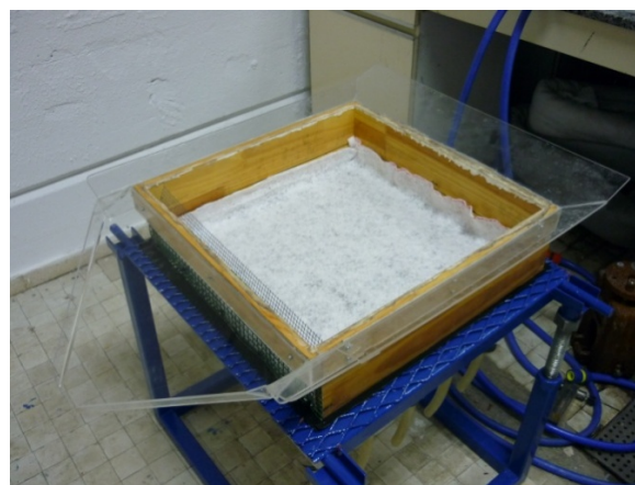
Figura 22. Disposición del geotextil en la probeta de pavimento permeable del ICF.
