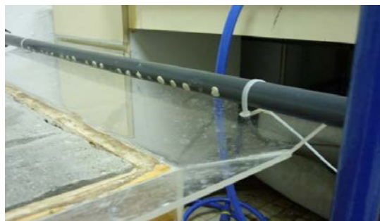
Figura 19. Perforación practicada en la estructura de metacrilato perimetral al marco de madera (izquierda) y posterior fijación del tubo perforado mediante bridas de plástico (derecha).
