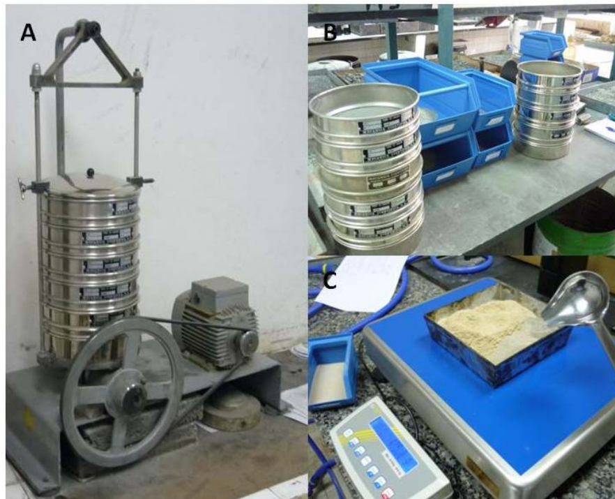
Figura 35. (A) Preparación de los sedimentos con los tamices UNE y (B) las bandejas para dividir los distintos tamaños de sedimento, y (C) pesado de bandeja con la mezcla final de sedimento.
