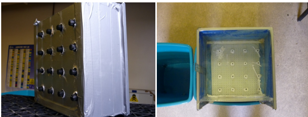
Figura 41. Configuración final del simulador de lluvia PLR con los goteros ajustables.
