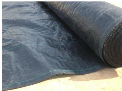
**Figura 6-1. Geo textil (tomado de: <http://hogar.pisos.com>)**
