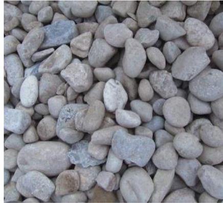
**Figura 6-4. Gravas (Proton *et al.*, 2008)**
