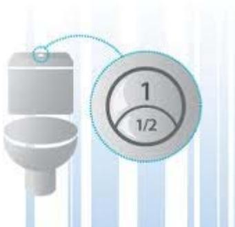
La simple sustituci3n del tradicional mecanismo de descarga por otro que disponga de doble pulsador permite ahorrar hasta un 60% del agua consumida. El usuario puede escoger el volumen de descarga en funci3n del uso realizado.
