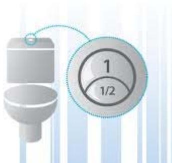
La simple sustitución del tradicional mecanismo de descarga por otro que disponga de doble pulsador permite ahorrar hasta un 60% del agua consumida. El usuario puede escoger el volumen de descarga en función del uso realizado.
