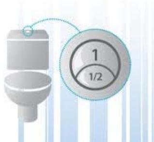
La simple sustituci3n del tradicional mecanismo de descarga por otro que disponga de doble pulsador permite ahorrar hasta un 60% del agua consumida. El usuario puede escoger el volumen de descarga en funci3n del uso realizado.
