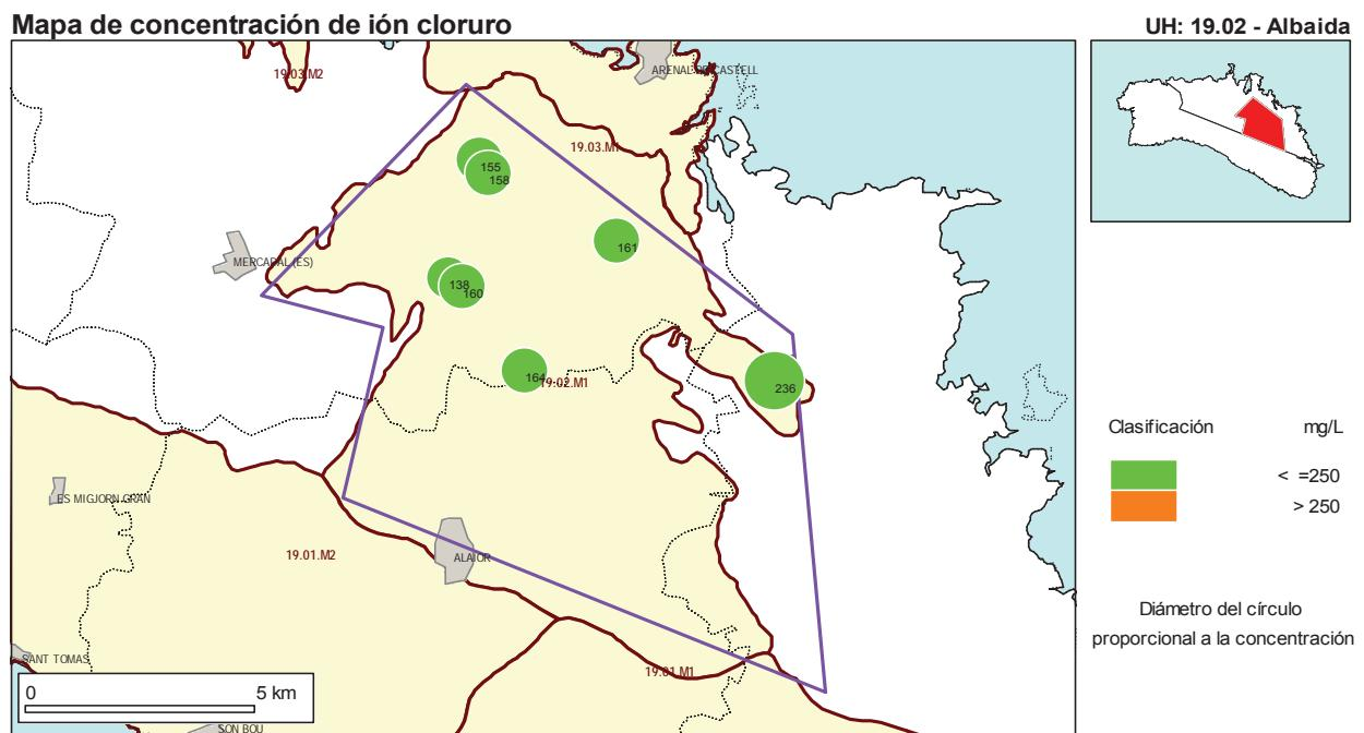
Para octubre de 2008, los valores de concentración de ión cloruro varían entre los 152.00 mg/L de valor mínimo y los 182.00 mg/L de máximo, con una media de 163.00 mg/L y 160.00 mg/L de mediana (7.60 mg/L de desviación típica).
