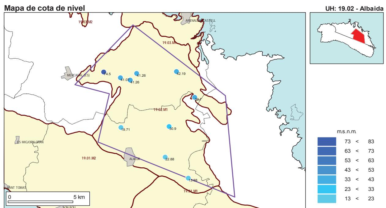
Para octubre de 2008, los valores de cota de nivel varían entre los 13.79 m.s.n.m. de valor mínimo, en el municipio de Alaior y los 75.34 m.s.n.m. de máximo, en Mercadal, con una media de 36.52 m.s.n.m.; y 39.75 m.s.n.m. de mediana, (11.44 m.s.n.m. de desviación típica).
